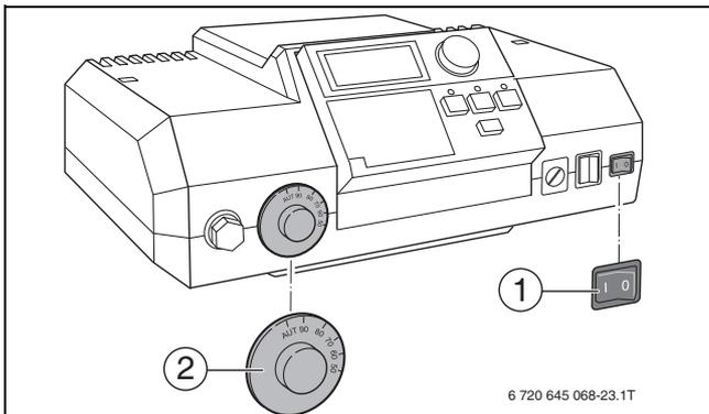
Рис. 6 Включите отопительную установку на системе управления (Logamatic 2000)
