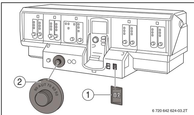
Рис. 7 Включите отопительную установку на системе управления (Logamatic 4000)
